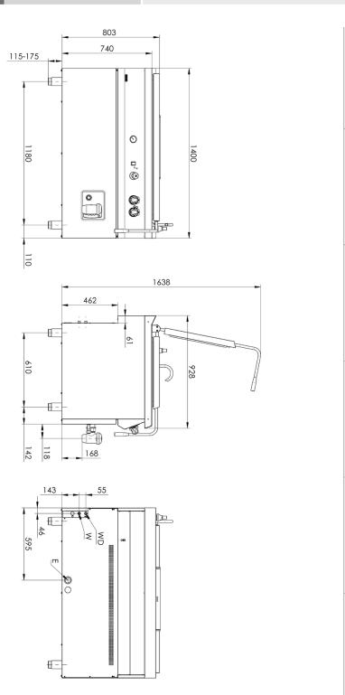
E - přívod napětí 400V WD - přívod vody do duplikátrou W - přívod vody
